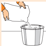
Figura 22: Versare FERMACELL Stucco per giunti in acqua
