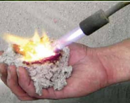
**climacell®** è straordinariamente adatto per la coibentazione di intercapedini perché i fiocchi di cellulosa, insufflati a pressione, sigillano ogni vuoto al 100% anche se difficilmente accessibile e di forma irregolare. In tal modo si crea un cappotto sagomato e stabile, garantito da una densità minima di 30-65 kg/m<sup>3</sup>, a seconda dell'applicazione, posato a regola d'arte con macchinari appositi.
